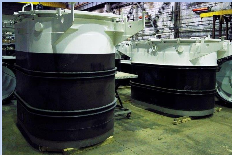
Колодец для подземного укрытия патрубка вантуза КВГ
